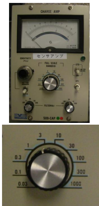
図1 測定対象製品とロータリースイッチ
